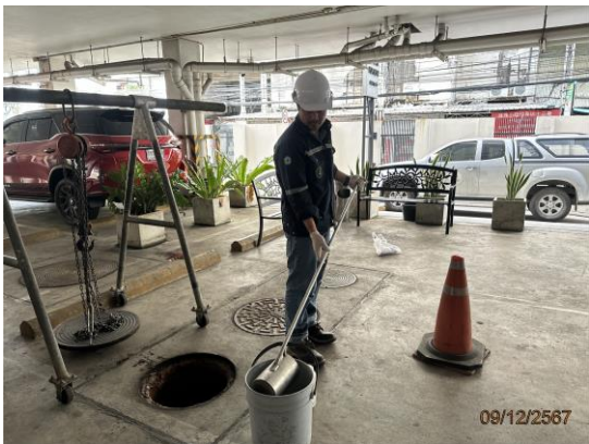
รูปที่ 3-2 การเก็บตัวอย่างคุณภาพน้ำทิ้ง บริเวณจุดเก็บน้ำก่อนผ่านระบบบำบัด ถึงที่ 1
